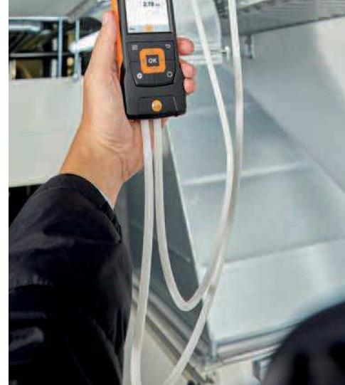
Для измерения объёмного расхода при высоких скоростях потока или в сильно загрязнённом воздухе мы рекомендуем использовать модель testo 440 dP с трубкой Пито
